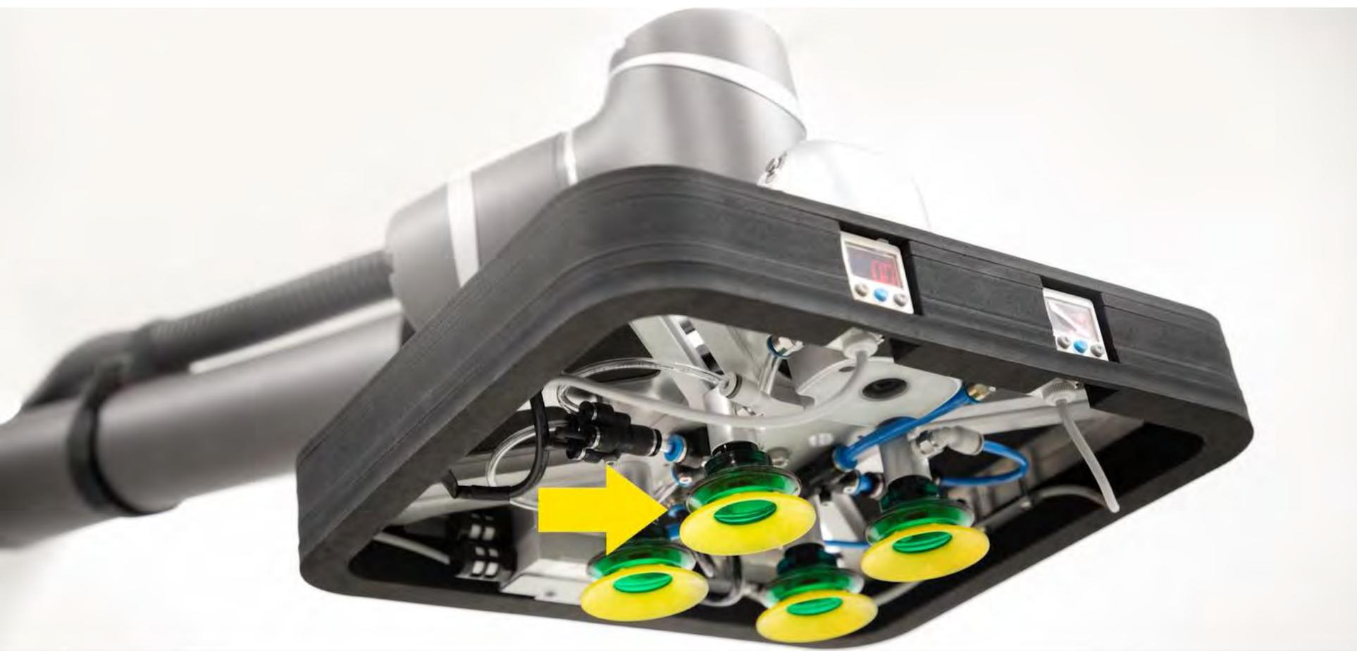
調整可能なグripper: カートンサイズに応じて、吸着パッドを調整することができます。
