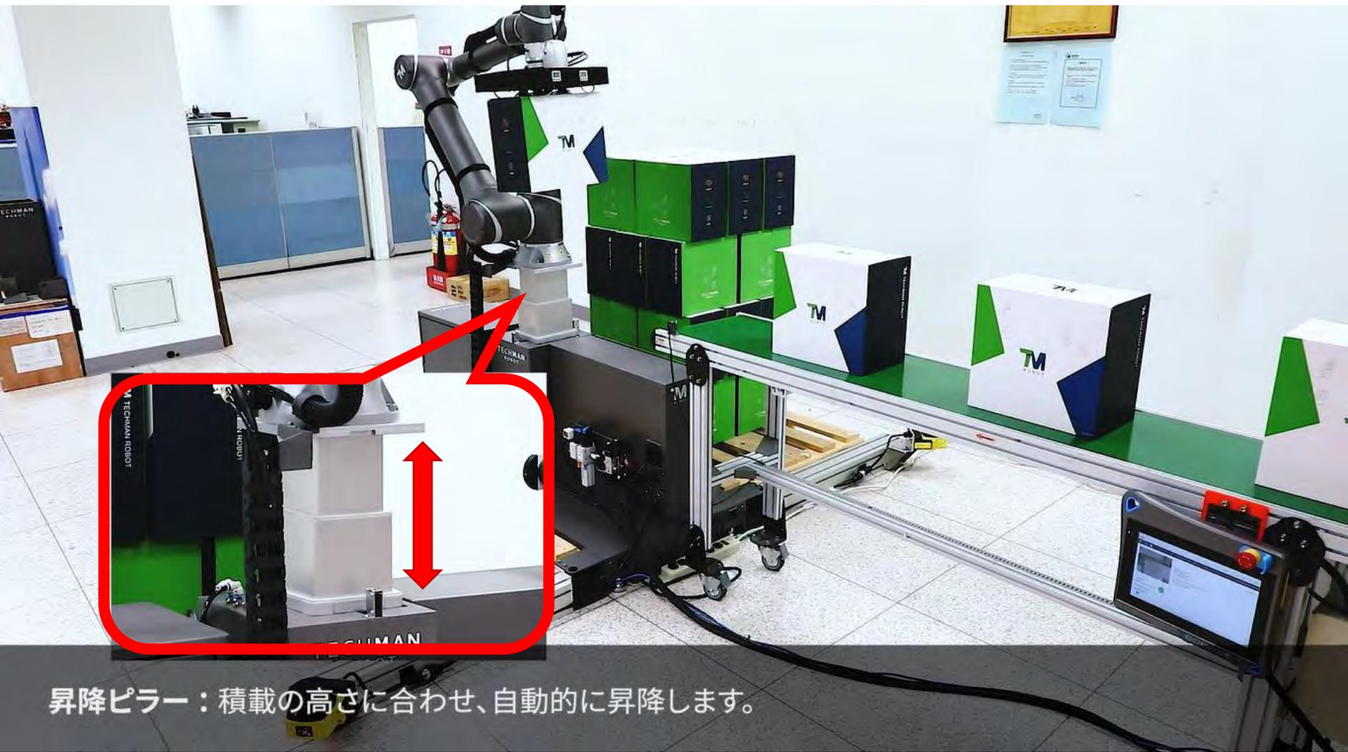
昇降ピラー：積載の高さに合わせ、自動的に昇降します。
